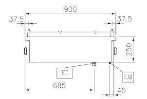
Electrical inlet (power) Equipotential screw
